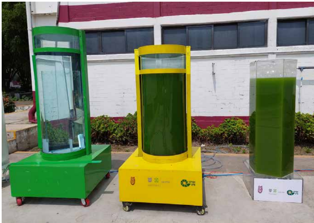
Sistemas de producción de microalgas (fotobiorreactores) para el tratamiento de aguas residuales y purificación de aire
