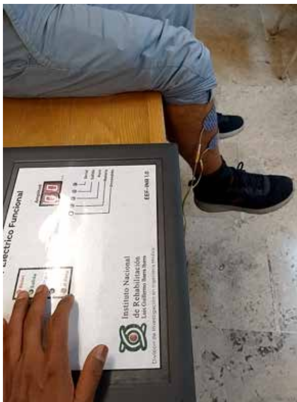
Estimulador Eléctrico Funcional conectado al músculo tibial anterior de un voluntario sano
