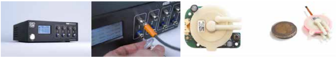
Sistemas de bombeo para la introducción de reactivos a la plataforma microfluidica.
