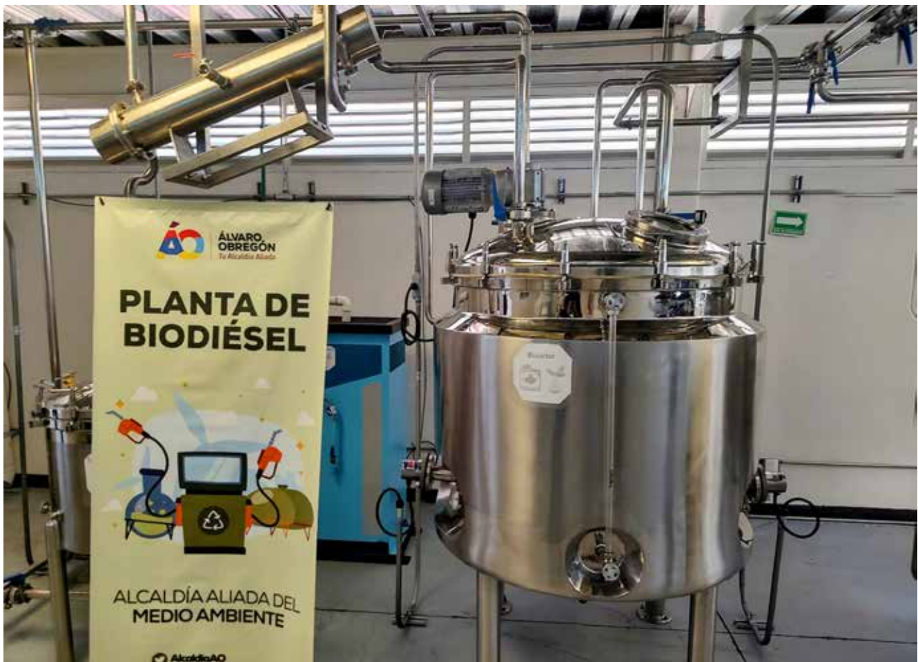
Planta productora de biodiésel a partir de aceite vegetal residual, Alcaldía Álvaro Obregón
