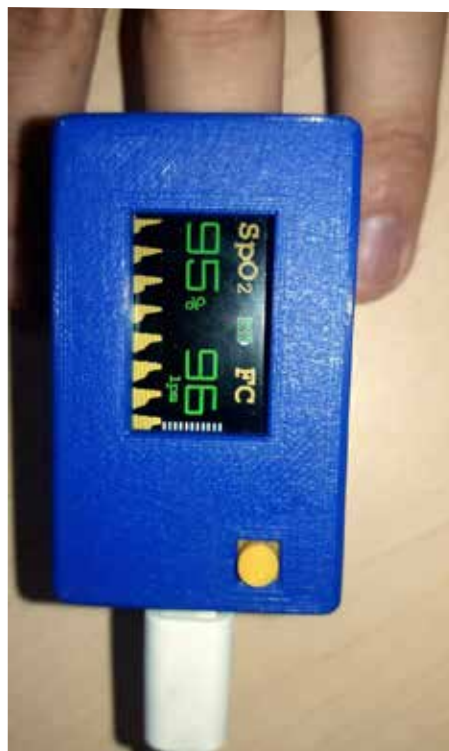
Prototipo de oxímetro de pulso OxiPuma, con un buen desempeño en mediciones de SpO2 y FC en un diseño compacto, batería recargable de ion-litio y comunicación Bluetooth con un dispositivo móvil.
