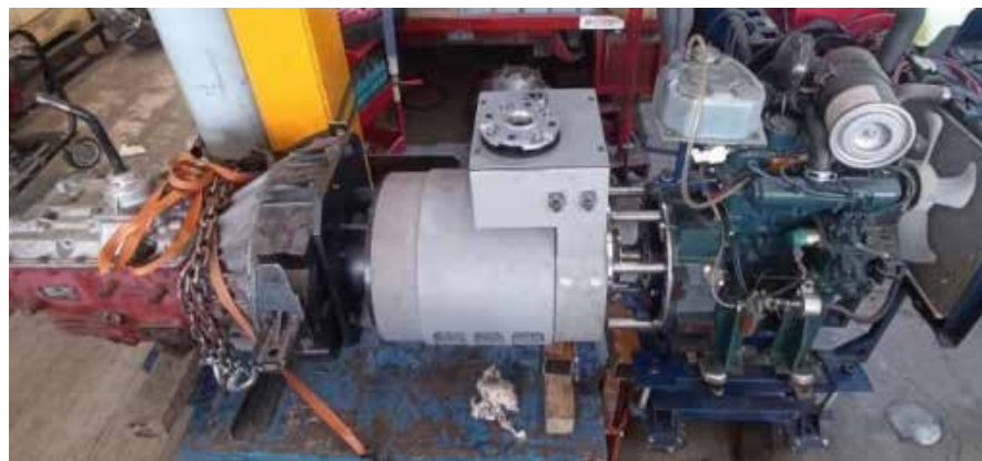
Sistema de tracción eléctrica para camiones de 2.5 toneladas
