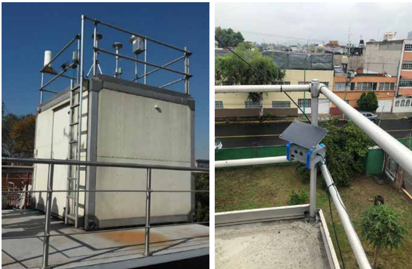
Dispositivos móviles y fijos usados para el monitoreo de la calidad de aire en la Ciudad de México
