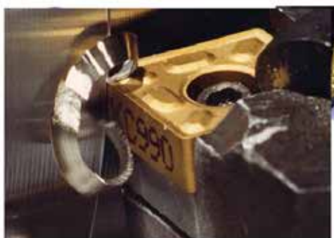
Corte de barra de acero usada como prueba
