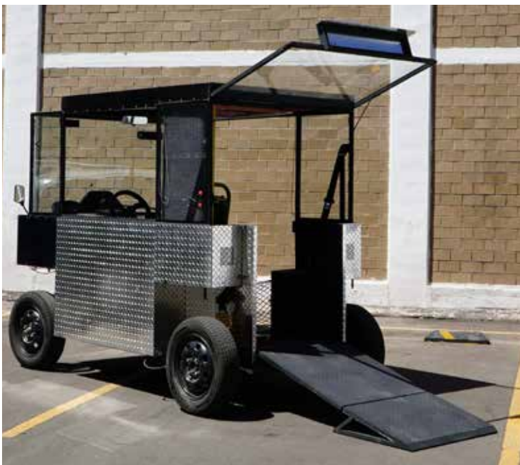
Prototipo de un vehículo eléctrico ligero para ser utilizado como mototaxi
