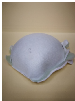
Figura 12.- Mascarilla con tiempo de sellado de 5 s y amplitud de 90 %
