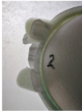
Figura 6.- Junta de sellado con tiempo de 5 s y amplitud de 90 %
