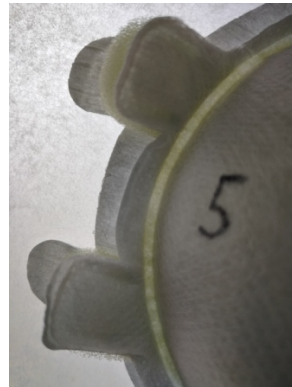
Figura 9.- Junta de sellado con tiempo de 5 s y amplitud de 95 %
