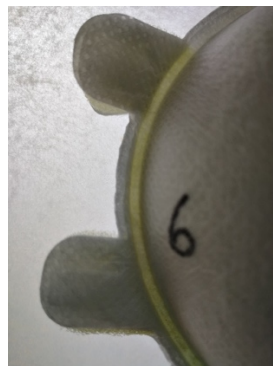
Figura 10.- Junta de sellado con tiempo de 7.5 s y amplitud de 95 %.
