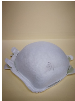
Figura 13.-Mascarilla con tiempo de sellado de 7.5 s y amplitud de 90 %.
