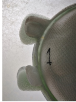
Figura 5.- Junta de sellado con tiempo de 2 s y amplitud de 90 %
