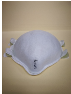
Figura 15.- Mascarilla de sellado de 5 s y amplitud de 95 %
