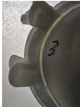
Figura 7.- Junta de sellado con tiempo de 7.5 s y amplitud de 90%
