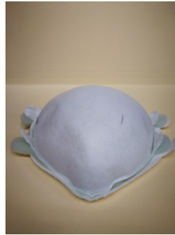
Figura 11.- Mascarilla con tiempo de sellado de 2.5 s y amplitud de 90%
