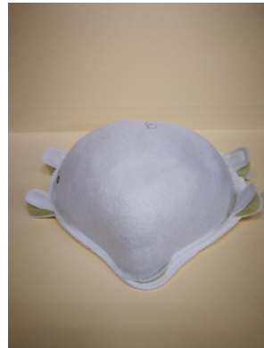
Figura 16.- Mascarilla con tiempo de sellado de 7.5 s y amplitud de 95 %.
