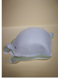
Figura 14.- Mascarilla con tiempo de sellado de 2.5 s y amplitud de 95 %.
